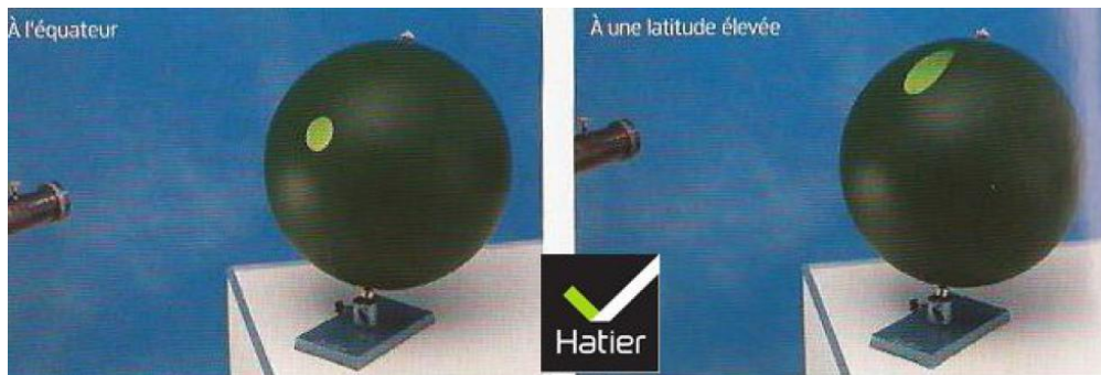
Document 2: Expérience de mesure des températures à l'équateur (image de gauche) et aux pôles (image de droite)
